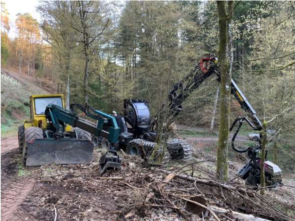
Abbildung 3: Zangenschlepper mit Seilen (links) und Radharvester (rechts) im Wolfental
